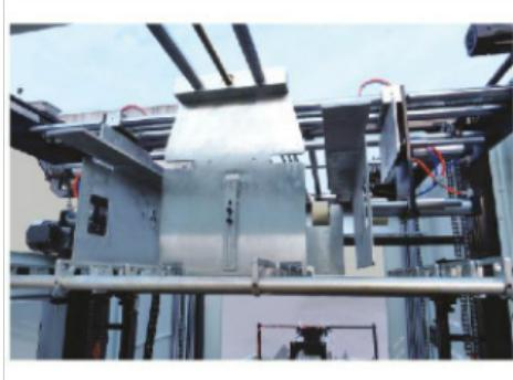
链条皮带式翻转机：链条皮带式翻转机翻转工艺流程：底盘到位→安装翻转皮带→调翻转皮带位置→起升底盘→底盘翻转→放置底盘→拆卸翻转皮带→翻转机回转并停留在等待位。目前，链条皮带式翻转机所使用皮带通常是专门齿形带，其结构为内层纤维层，外层敷设聚氨酯保护层。这种结构能够有效保护底盘外观，同时使翻转工作平稳进行。由于其翻转受力点通常布置在前、后桥中心点，翻转过程受力分布均匀，因此能够有效避免翻转过程中所造成的底盘弯曲和扭曲等质量缺陷。但链条皮带式翻转机也存在着一些缺点，即翻转皮带价值较高，损耗量较大；同时因皮带与链条为开口结构，其翻转机设置离地高度较高，通常翻转机构布置离地高度较高，约为7m。青岛翻转机供应商板材翻转机：提高产品质量，同时降低了操作人员的劳动强度。
